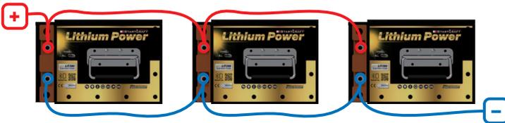
4 x LIT200 - 12V Erhöhung der Kapazität auf 800Ah = 10240Wh = 10,24kWh
