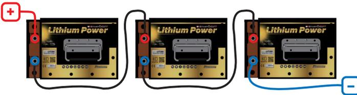
4 x LIT200 - 200Ah Erhöhung der Spannung auf 48V
