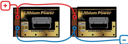
3 x LIT200 - 12V Erhöhung der Kapazität auf 600Ah = 7680Wh = 7,68kWh
