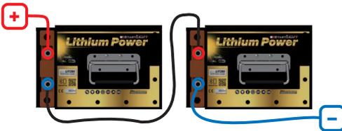
3 x LIT200 - 200Ah Erhöhung der Spannung auf 36V
