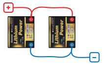
3 x LIT50 - 12V Erhöhung der Kapazität auf 150Ah = 1920Wh = 1,92kWh
