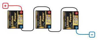
4 x LIT50 - 50Ah Erhöhung der Spannung auf 48V
