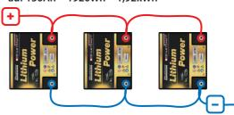
4 x LIT50 - 12V Erhöhung der Kapazität auf 200Ah = 2560Wh = 2,56kWh
