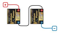
3 x LIT50 - 50Ah Erhöhung der Spannung auf 36V
